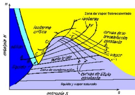
Dentro de la curva o campana, ocurrirá el proceso de cambio de fase. Se debe tener claro que las isotermas (temperatura constante) y las isóbaras (presión constante) se confunden en una línea única que llamamos rectas de condensación. En el diagrama se lee directamente la presión. Para leer la temperatura es necesario subir por la recta de condensación y leer la temperatura en  $x=1$  (línea de vapor saturado).
